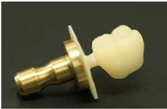
➤2 CERASMART-Krone unmittelbar nach dem Fräsen. Hier erfolgt die visuelle Kontrolle auf Fräsfehler.
