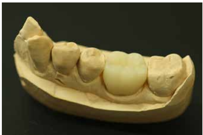
➤6 Zur Charakterisierung vorbereitete CERASMART-Krone auf dem Kontrollmodell
