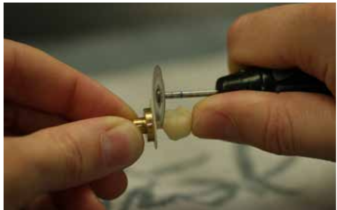
➤3 Trennung der Krone vom Halter mit einer diamantierten Trennscheibe
